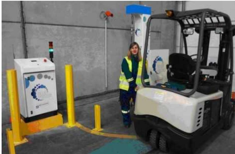
La pila de combustible GenDrive, que ha sido desarrollada por Hypulsion, joint venture entre Air Liquide y Plug Power, empresa especializada en este tipo de soluciones, es una alternativa superior a las baterías industriales de plomo-ácido para energía motriz. **Reemplaza las baterías sin necesidad de modificar el vehículo**, y tiene una vida útil entre 1,5 a 2 veces mayor que la de las baterías, lo que contribuye a disminuir los costes de explotación.
