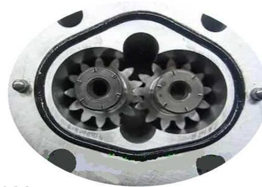
Las **bombas de engranajes** son bombas robustas de caudal fijo, con presiones de operación hasta 250 bar(3600psi) y velocidades de hasta 6000 rpm. Con caudales de hasta 250 cc/rev combinan una alta confiabilidad y tecnología de sellado especial con una alta eficacia.
