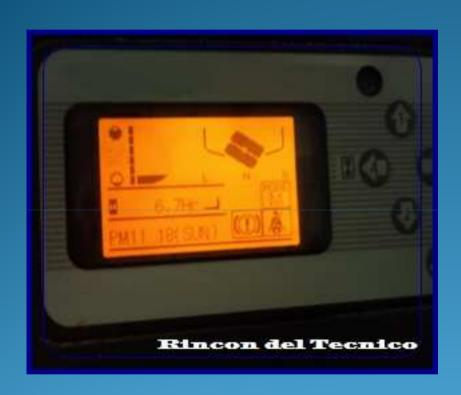
El **frenado regenerativo** en la carretilla elevadora, cuando reducimos la velocidad de la maquina o actuamos sobre el freno de pie, ha estado presente tanto en los motores de excitación en serie, que se realizaba a través de contactores y diodos de potencia, excitación independiente y en la actualidad motores de corriente alterna.
