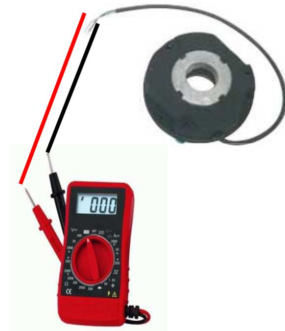
Nota: Fijaros bien en la temperatura de medición en las bobinas, si la temperatura es muy alta, las mediciones no serán correctas.
