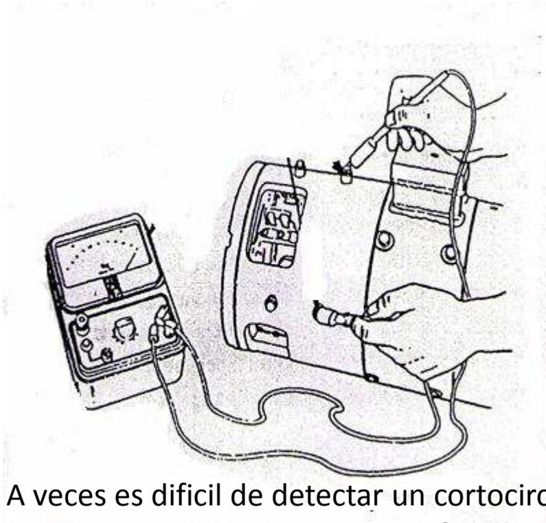
Prueba de cortocircuito en las bobinas inductoras. Como veis en la imagen con el polímetro comprobaremos la resistencia de las bobinas inductoras, normalmente no suelen ser superior a 1 Ohmio. Comprobaremos el aislamiento con respecto a la carcasa, colocando las pinzas del polímetro una en la conexión de la bobina y otra en la carcasa del motor. No debería de haber continuidad, en las medidas con ambas bobinas.
