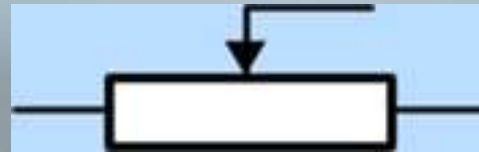
Simbología potenciómetro variable
